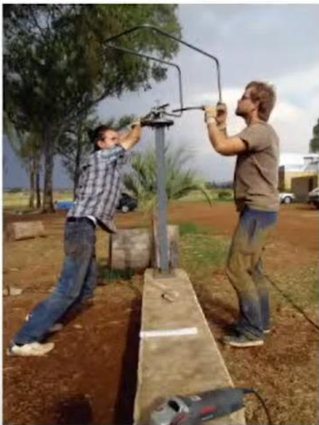
// Krivljenje vodovodnih cevi za izdelavo pohištva // Bending of metal water pipes for furniture
