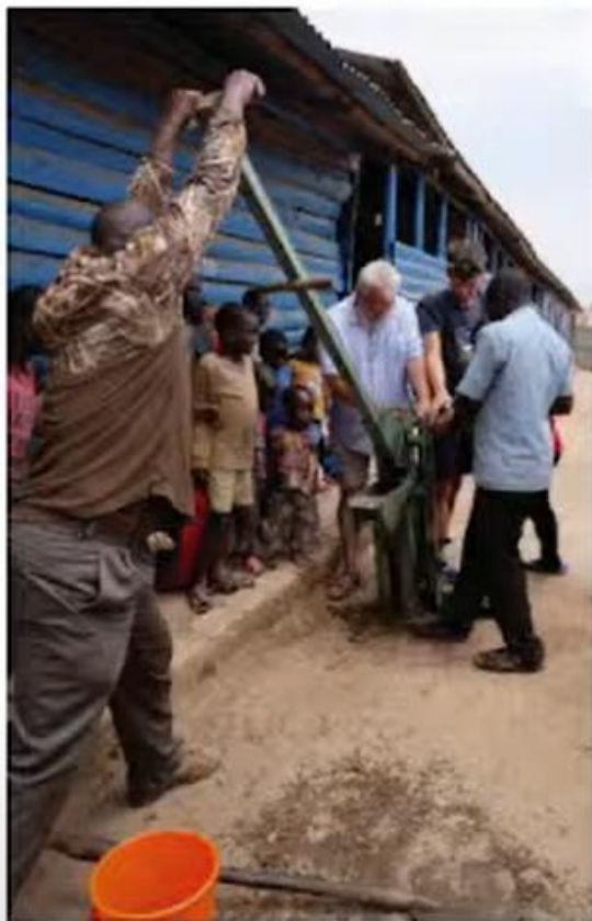
// Stavba Amasko je zidana iz zidakov iz prsti - njihova izdelava in prodaja naj bi omogočila finančno samovzdržnost Amasko // The Amasko building is built of soil bricks - their production and sale would enable financial self-sufficiency of Amasko.
