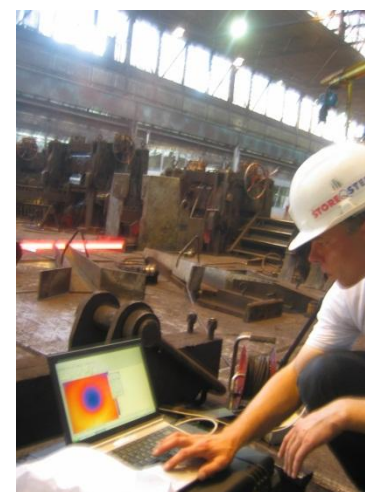
valjanje jekla infrardeča termografija
