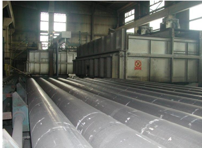
proces homogenizacije Al-4.5%Cu, ~ 8 h, ~ 420 C
