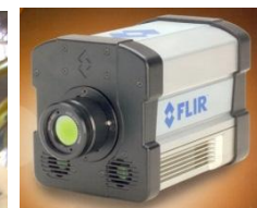
Polna ločljivost InSb detektorja: 640 x 512 točk. Hitrost zajema podatkov do 125 Hz pri polni ločljivosti.
